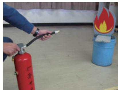
ホース先端のノズルを外し、ノズルを火元に向けます。
