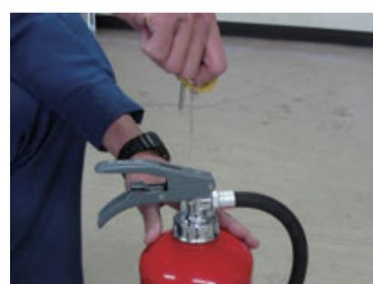
消火器の安全ピン(黄色い取っ手がついている部品)を上強く引っ張り、引き抜きます。
